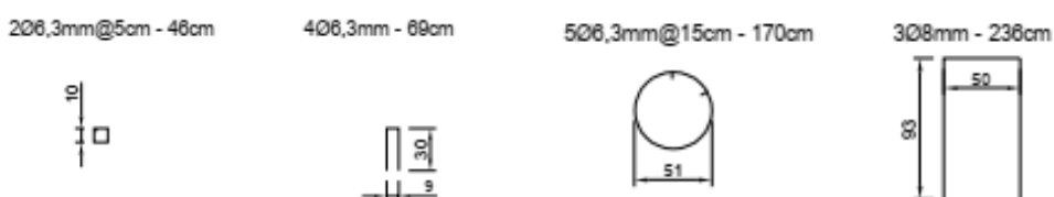
Figura 5 – Detalhes das armaduras (CA-50)
